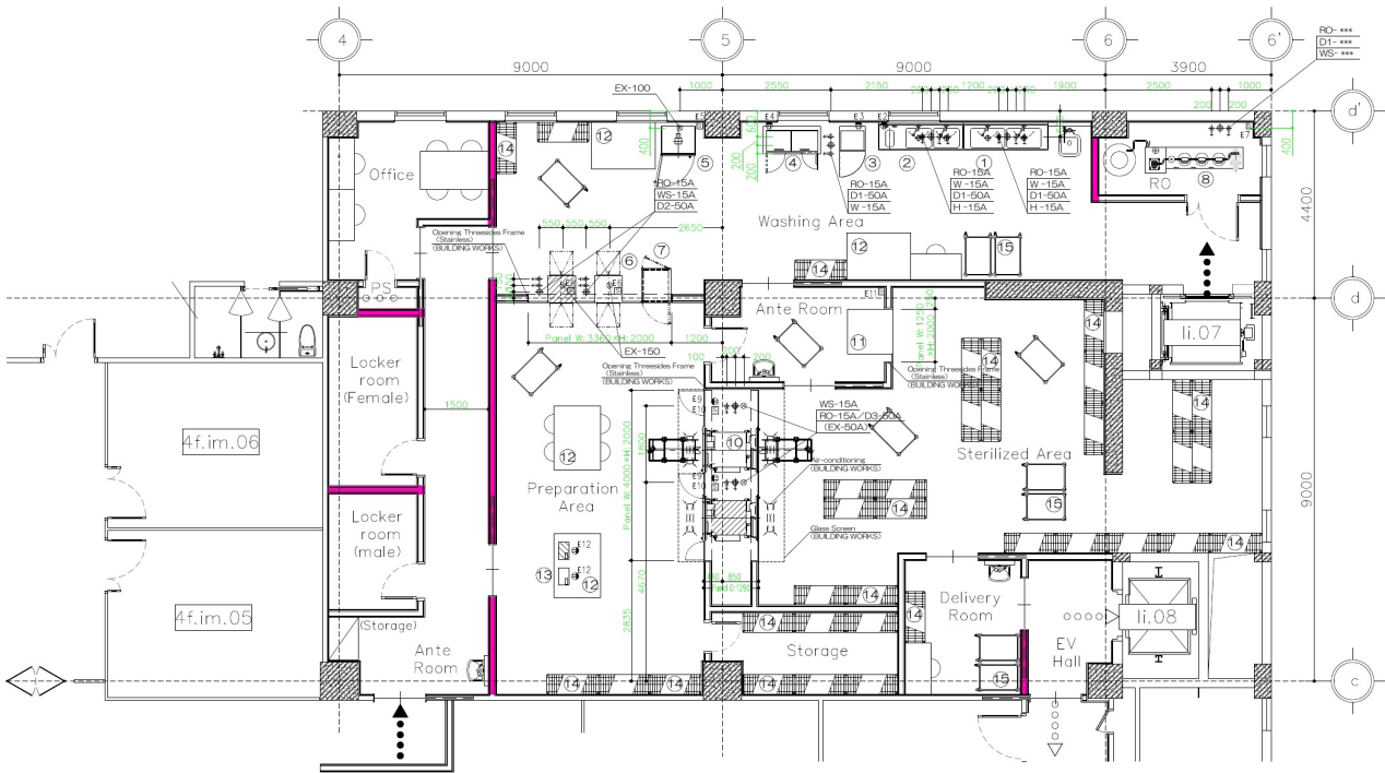
Một mặt bằng phân khu đơn vị tiệt khuẩn trung tâm mà JVC và Sakura Seiki đã thiết kế cho khách hàng
